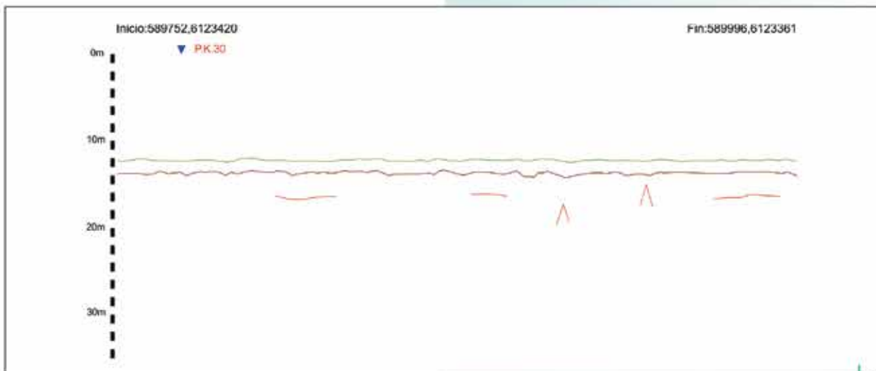
Figura 16. Gráfica: Sección del canal en el pk. 30. En verde se representa el fondo y en color marrón el límite del firme. En rojo se muestran reflectores secundarios
